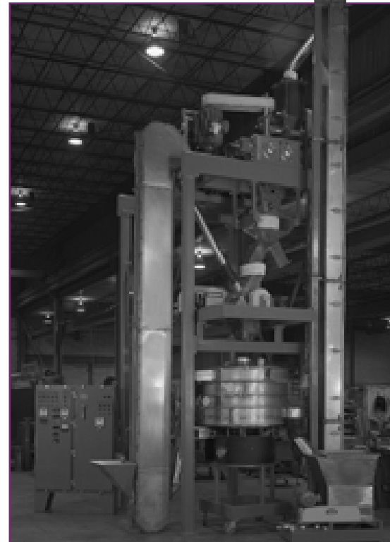
Systèmes de compactage/granulation continus avec criblage et recyclage (voir schéma du système I)
